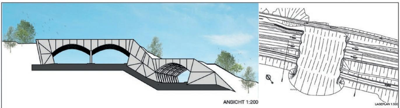
Abb. 7: Tunnelportal mit Dreiecks- und Viereckselementen
