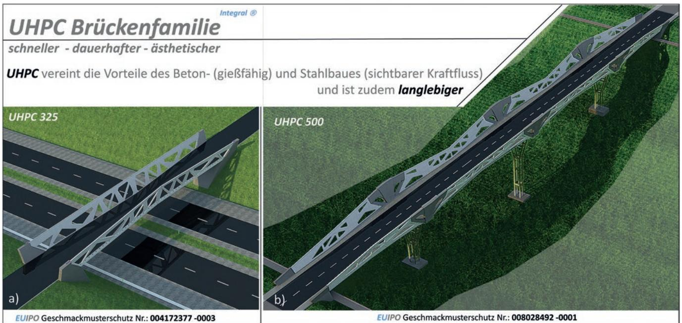
Abb. 10: UHPC Brückenfamilie a) Brückentyp UHPC 325 als Rahmen b) Brückentyp UHPC 500 als Durchlaufsystem
